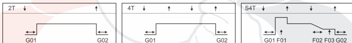
Рис. 6 Иллюстрация режимов работы сварочной горелки.
