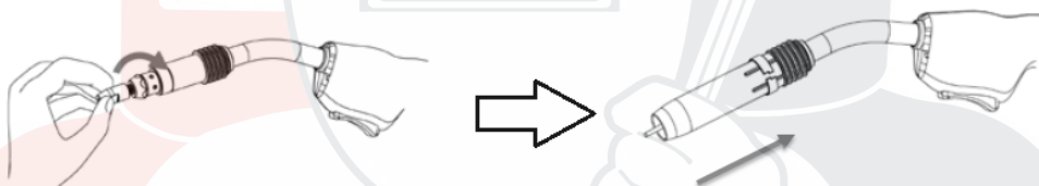
Рис. 10. Установка наконечника и сопла горелки.
