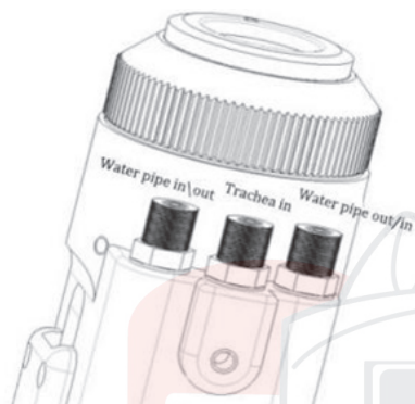
Схема подключения охлаждения и подачи газа.
