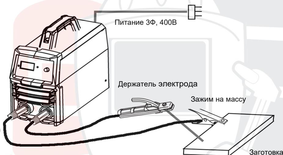
Установите аппарат ровную горизонтальную поверхность. Для обеспечения нормальной вентиляции соблюдайте дистанцию от стен и внешних предметов от 50см. Удалите от места работ чувствительные электроприборы на безопасное расстояние.
