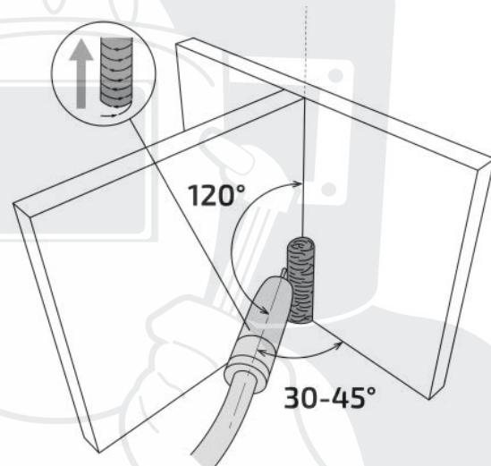
Угол наклона горелки при сварке тонколистового металла.
