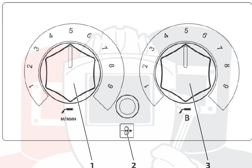
Рис. 7.0.2. панель управления механизмом подачи сварочной проволоки.
