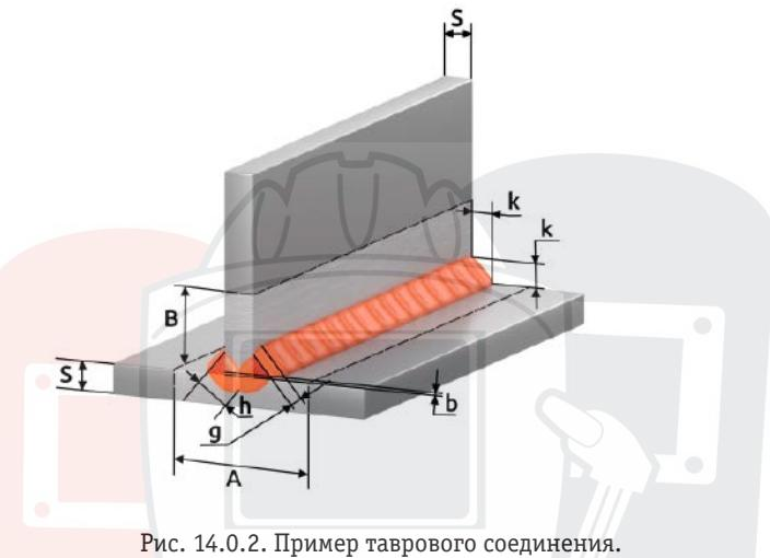
Рис. 14.0.2. Пример таврового соединения.
