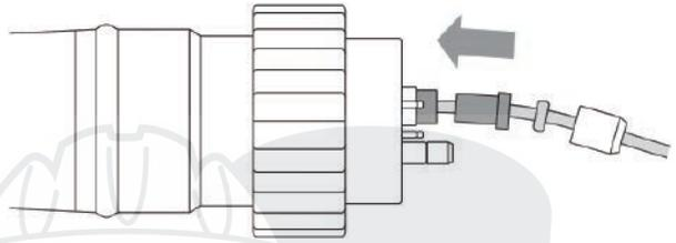
9. Закрутите прижимную гайку с помощью инструмента.
