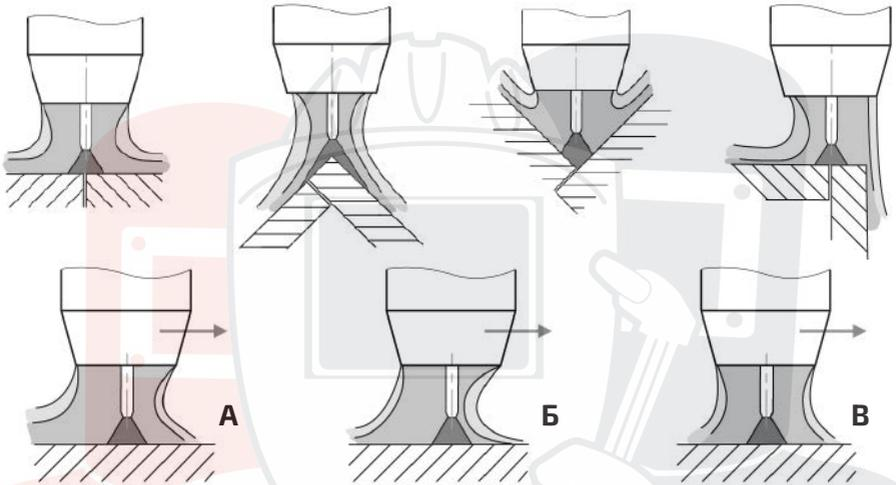
Рис. 9.9.2. Влияние типа соединения на форму потока.
