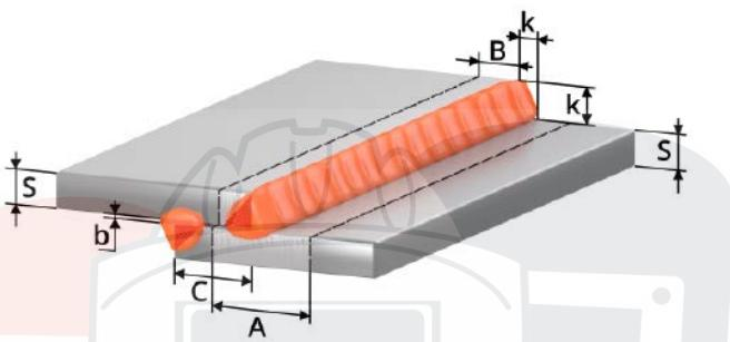
Рис. 14.0.5. Пример нахлесточного соединения.
