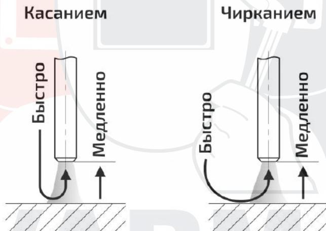
Рис. 11.0.1. Способы зажигания сварочной дуги.
