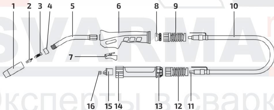
Рис. 9.2.1. Схема горелки для МIG сварки.
