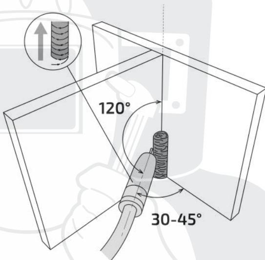
Угол наклона горелки при сварке тонколистового металла.
