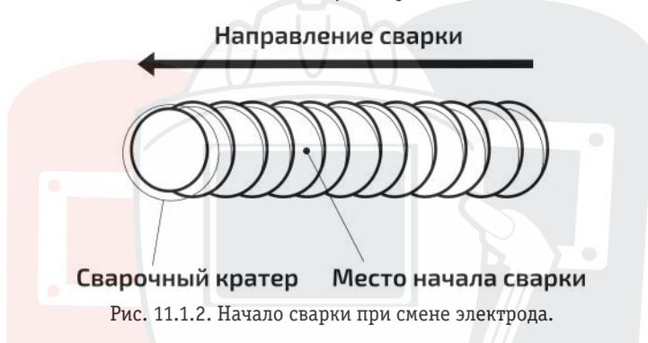
Рис. 11.1.2. Начало сварки при смене электрода.
