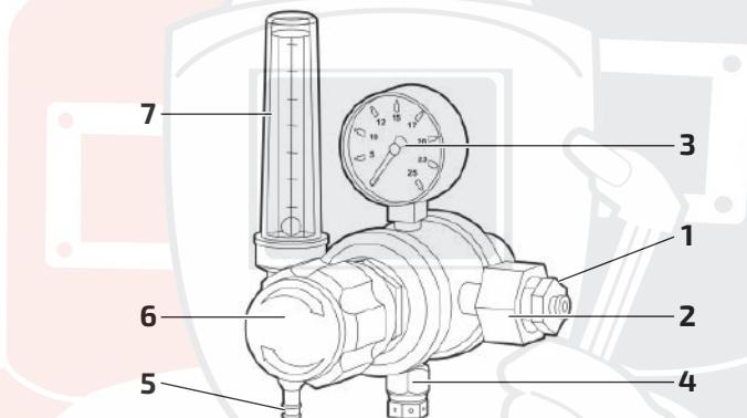
Рис. 9.10.1. Двухступенчатый регулятор расхода газа с ротаметром.
