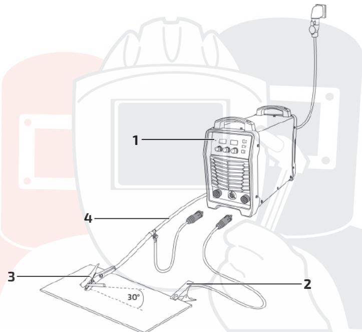
Рис. 12.0.1. Схема подключения оборудования.
