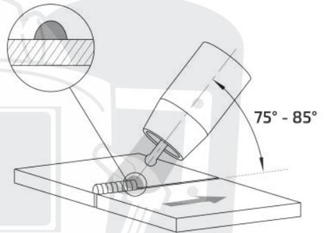
Сварка «от себя», узкий шов, большая глубина проплавления.
