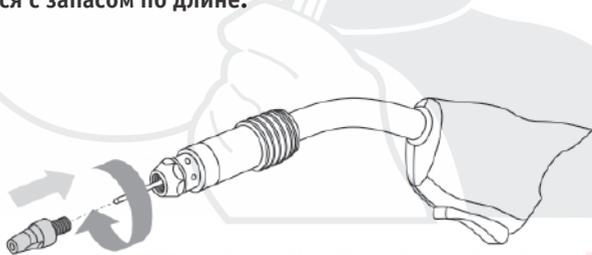
10. Закрутите прижимную гайку с помощью инструмента.
