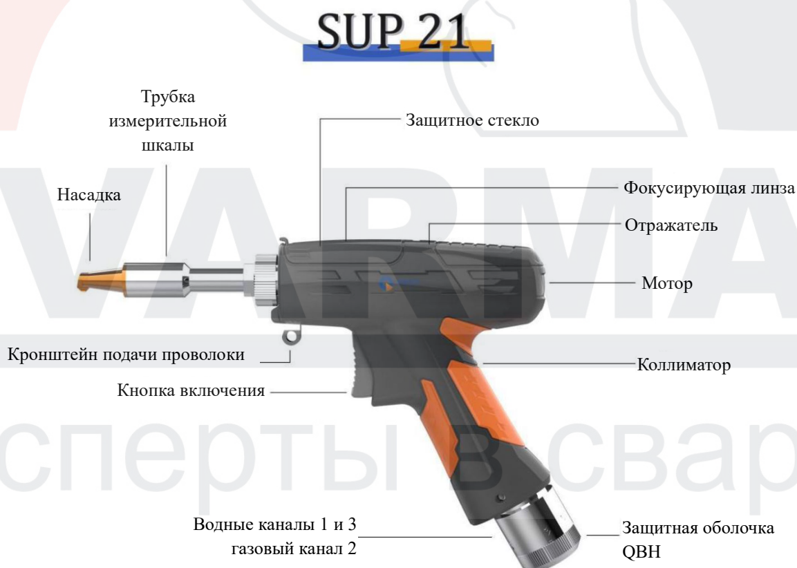
Схема сварочного узла SUP-21T
