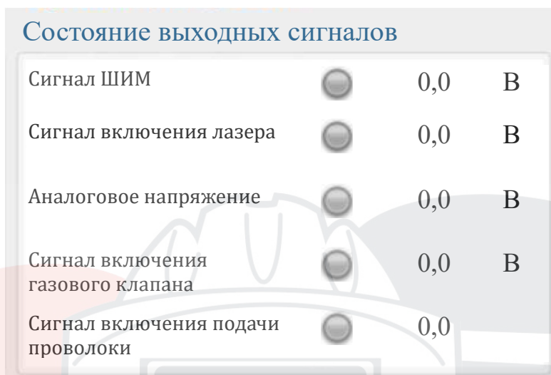
Рисунок 5.12 — Страница мониторинга — Индикатор состояния выходных сигналов
