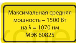
Знак, описывающий характеристики установленного лазерного излучателя.
