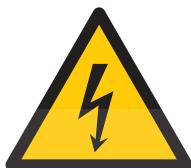
Предупреждающий знак, обозначающий, что при открытии находящейся под ним панели или кожуха возможно поражение электрическим напряжением.
