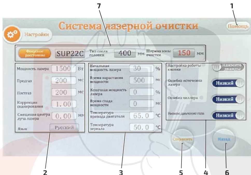
Фото 7.0.6. Главные настройки источника с фокусирующей линзой F400.
