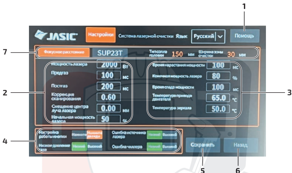
Фото 14.0.5. Главные настройки источника с фокусирующей линзой F150.
