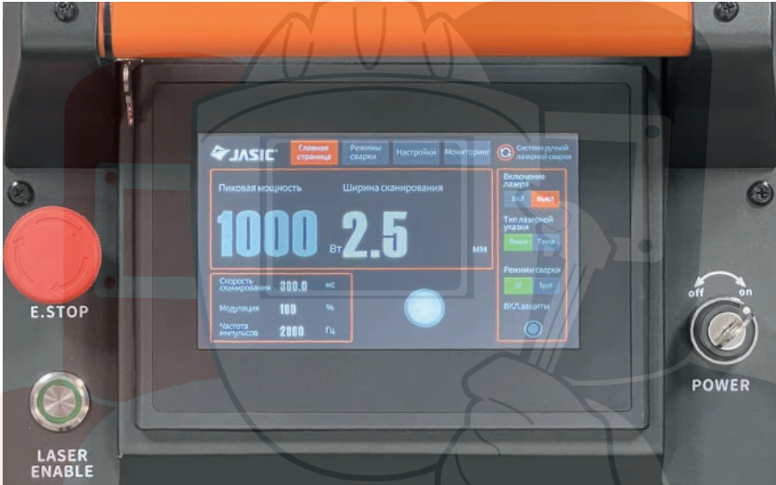
Фото 13.0.1. Общий вид панели управления включенного аппарата.
