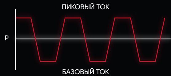
**MIG Pulse** – режим сварки с импульсной подачей тока, при котором происходит чередование базового и пикового уровней. Это обеспечивает более точный контроль плавления металла и особенно эффективно при сварке тонких материалов и металлов с высокой теплопроводностью, таких как алюминий и нержавеющая сталь.
