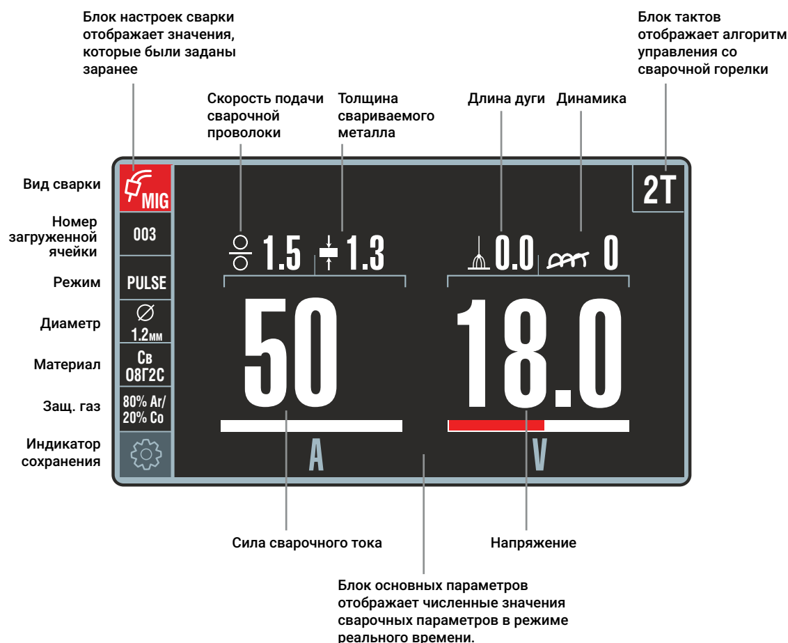
Рис. 20 — Блоки Главного экрана панели управления
