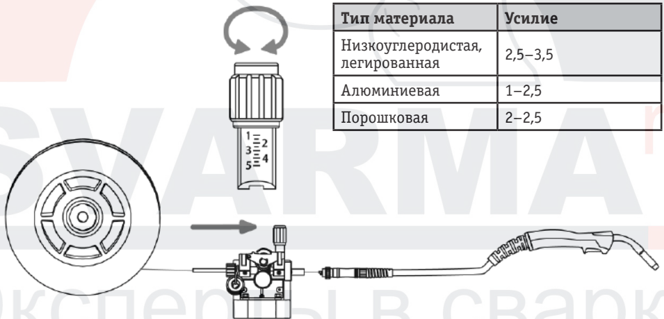
Рис. 9.7.3. Выбор усилия зажатия сварочной проволоки.
