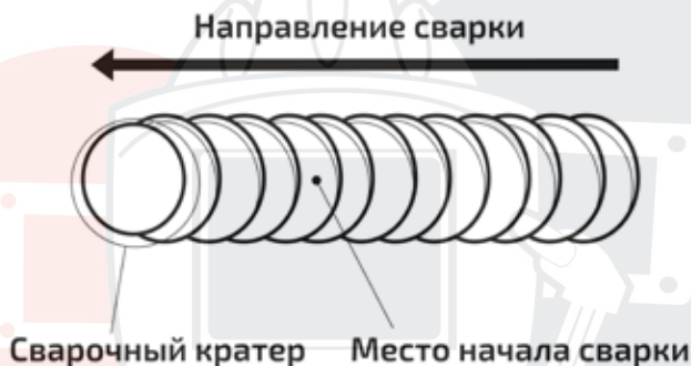
Рис. 11.1.2. Начало сварки при смене электрода.
